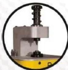
Questo strumento può **ricondizionare la sede conica della sfera** degli iniettori CR Bosch, che se danneggiata può causare eccessivi ricircoli e insufficienti portate di mandata. E' inoltre in grado di portare a misura gli spessori di riparazione.
